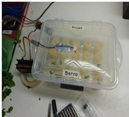
Figura 4.23 Monitoreo de temperatura y humedad en el contenedor.
