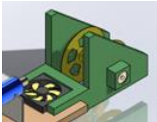
Figura 7. Método de recolección de filamento PLA a base de material reciclado del trabajo de Olger Jeyson Cutipa Mamani y Edgar Arián Rodríguez Flores.
