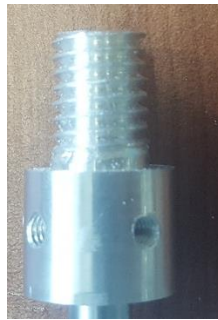
Figura 32. Accesorio con cuerda para el eje.
