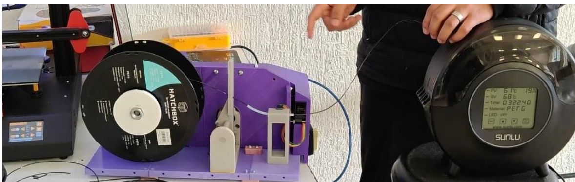
Figura 70. Pruebas de funcionamiento del enrollador.
