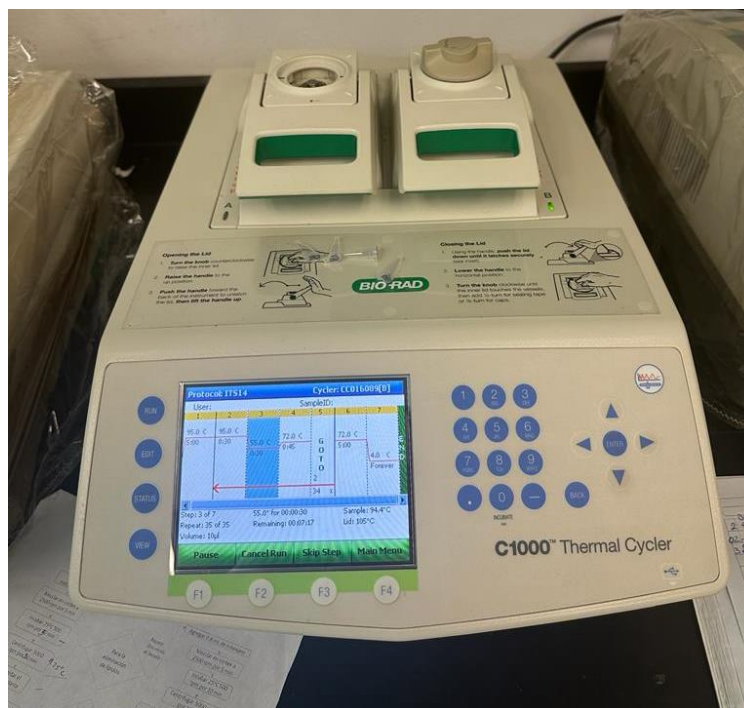
Figura 17. Uso del termociclador a temperaturas de 95°C, 55°C y 72°C.
