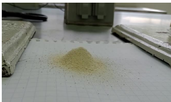
Figura 12. Determinación del ángulo de reposo en harina de pulpa de yuca inmadura
