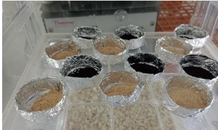
Figura 13. Determinación de humedad en pulpa de yaca madura e inmadura
