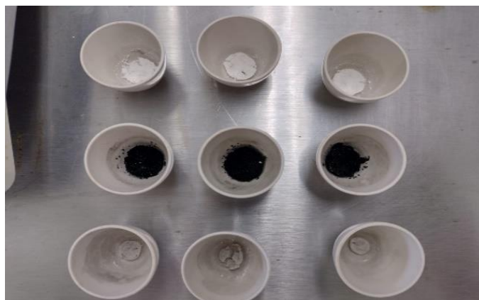
Figura 14. Determinación de cenizas en pulpa de yaca
